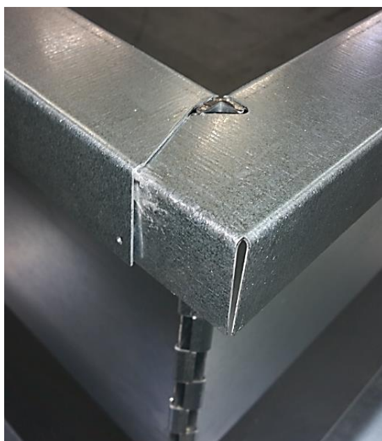
Rys. 25. Prawidłowo połączone ściany.
