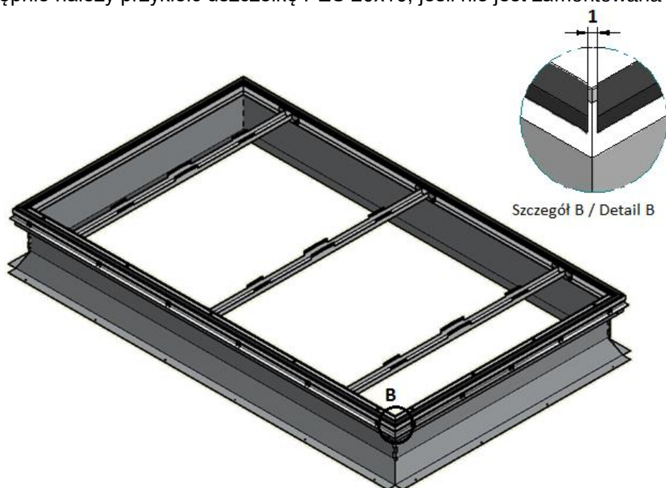
Rys. 45. Podstawa światlika FIX z zainstalowanym wieńcem wyposażonym w trawersy i uszczelkę PES 20x10.
